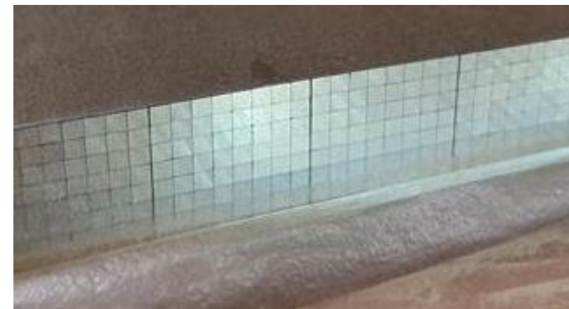
LYSO:Ce(Ca) fibers of size 1.94 \times 1.94 \times 100 \text{ mm}^3
